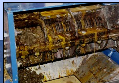
Mini Press operating on Cold Whole Rape Seed
